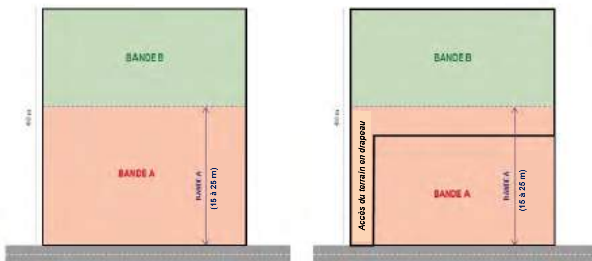
Schéma illustrant l'application des bandes de constructibilité
