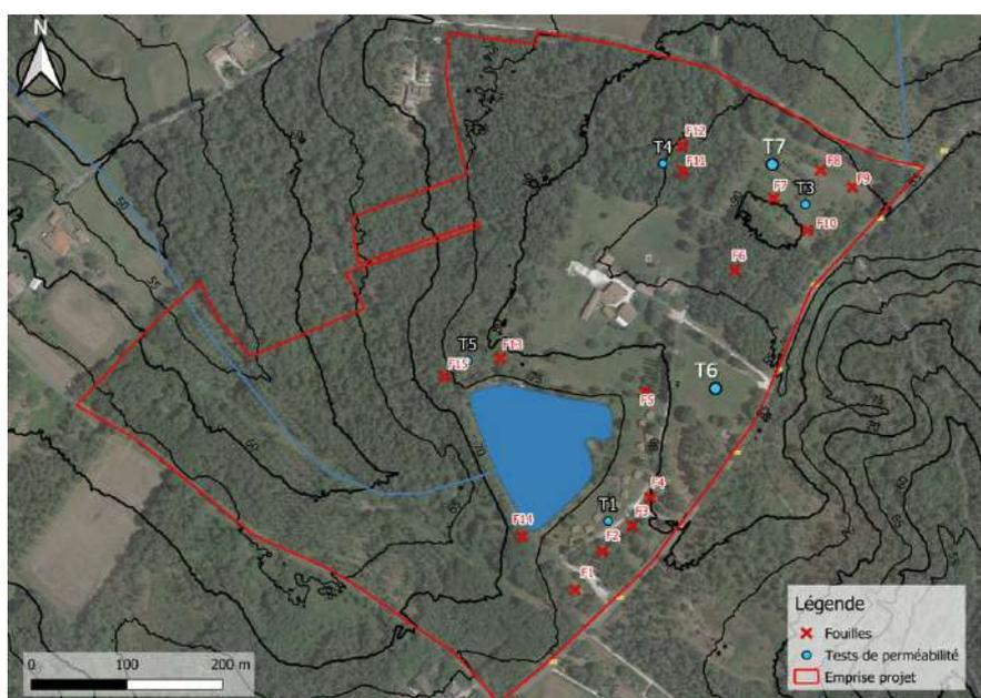
Localisation des tests de perméabilité de type Porchet
